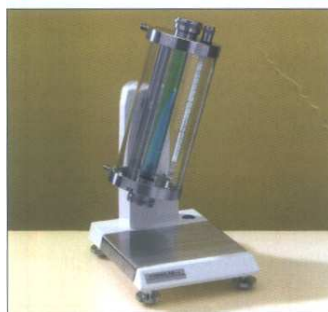
30. ábra Höppler-féle viszkoziméter képe és sematikus ábrája
